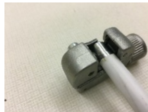
Grooving The Conduit
