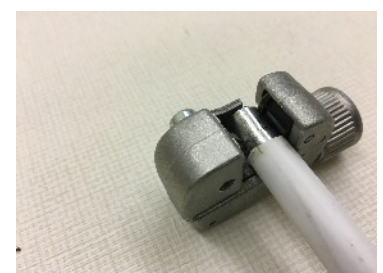
Grooving The Conduit
